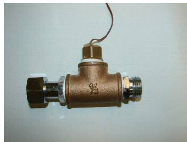
図 7.11.1 熱電対を取り付けた継ぎ手配管
